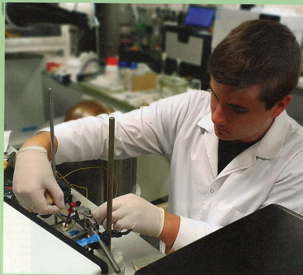
SIA "3D Strong" ķīmijas tehniķis Elmārs Spalva sagatavo elektriskiem un termoelektriskiem mērījumiem termoelektrisko ģeneratoru, veidotu no nanostrukturētiem materiāliem, iebūvētu siltumizolējošās putās.
